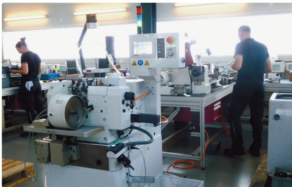
Chez Seuret SA. Au premier plan, la machine de taillage entièrement révisée et modernisée.
